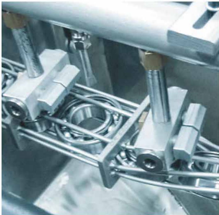
Rengøring med SILVENT 961 dyser til reduceret støj.
