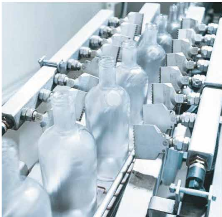
Tørring med SILVENT 973 dyser til bedre kvalitet
