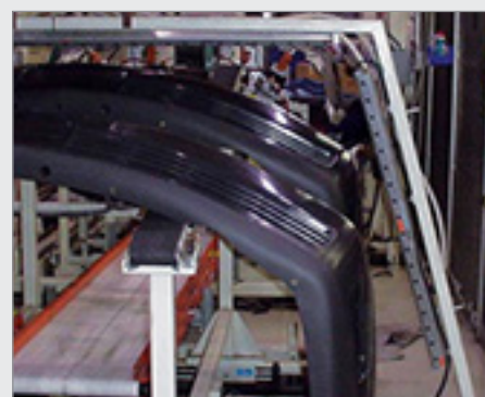
Karosserier renses for støv og fibre inden maling vha. en serie super ion luftknive.
