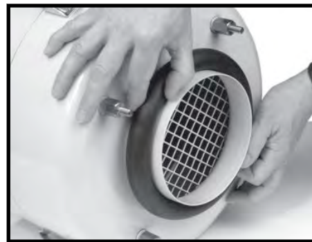
Trin 3. Monter skumkraveforsegling omkring indløbet tapp (Leveres med enhed).
