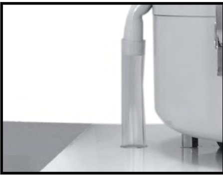
Trin 4. Monter oliereturrrøret og placeringsrøret for at dræne olie tilbage til maskinkabinet, sump eller opsamlingsbeholder.
